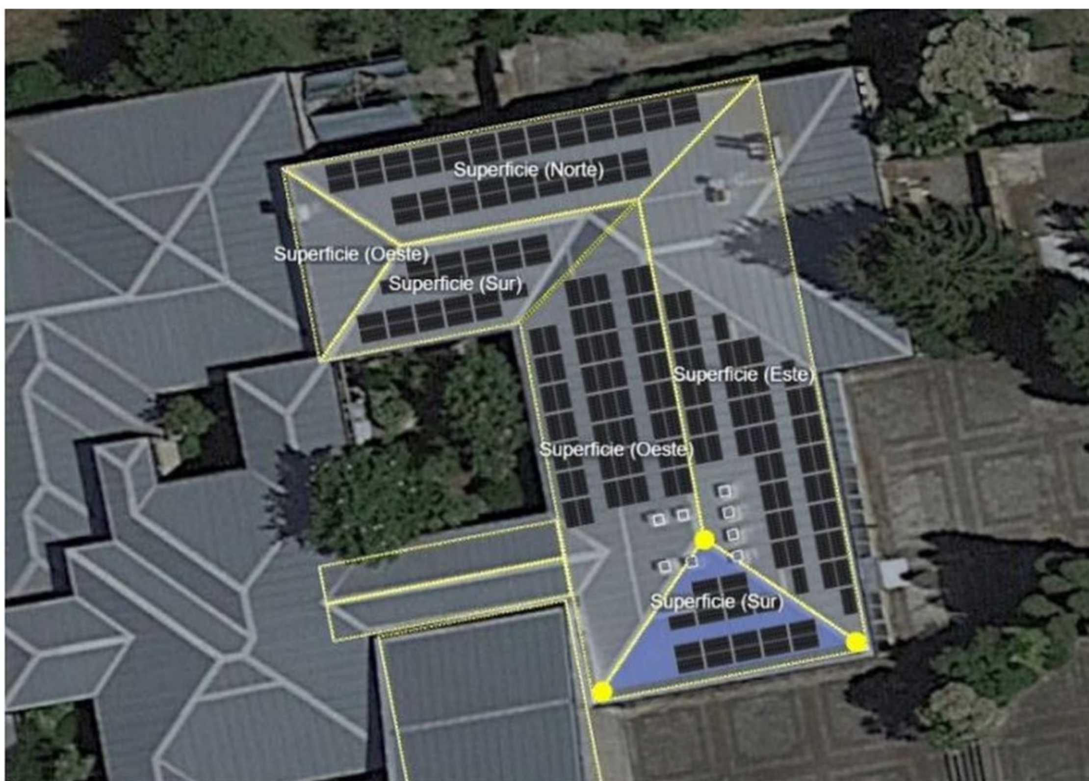
Plano de la instalación de placas fotovoltaicas en la cubierta de Filología y Traducción.
