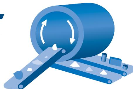
6. Un cilindro rotatorio clasifica los envases en función del tamaño. Una vez separados, la fracción menuda o fina (que por lo general no son envases) se rechaza y va directamente a la basura que acaba en el vertedero o en la incineradora. El resto sigue en la cinta transportadora para separarse por materiales.
