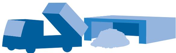
2. Los camiones descargan en la zona de recepción, generalmente soterrada, y desde allí se recogen los envases en una cinta transportadora para hacerlos entrar en la planta.
